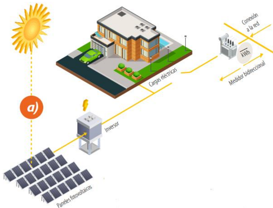
Figura 11 Sistema fotovoltaico con conexión a una red
