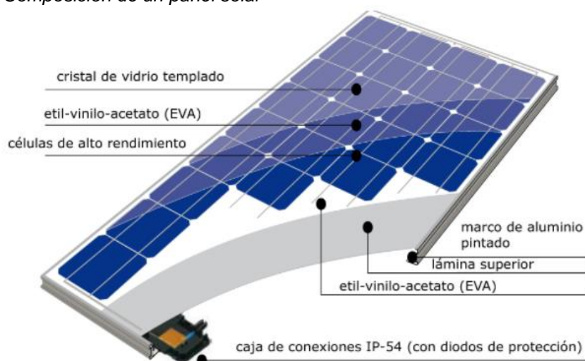
Figura 18 Composición de un panel solar
