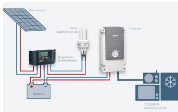
Figura 2. 8: Sistema fotovoltaico aislado. Fuente: (Vega Rojas, 2019)
