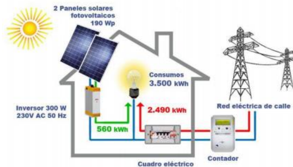
Figura 2. 7: Sistema fotovoltaico acoplado a la red. Fuente: (Vega Rojas, 2019)
