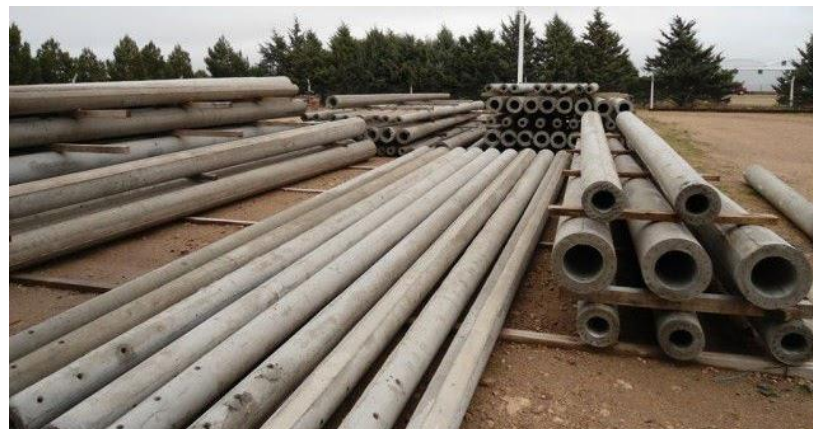
Figura 2.13. Postes cónicos de hormigón. Fuente: (Corporacion nacional de electricidad, 2019)
