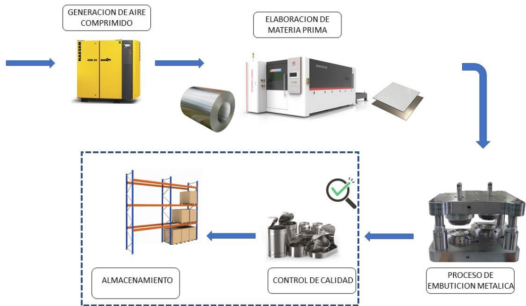
Figura 3. 7. Proceso general de elaboración de envases metálicos Fuente: El Autor.
