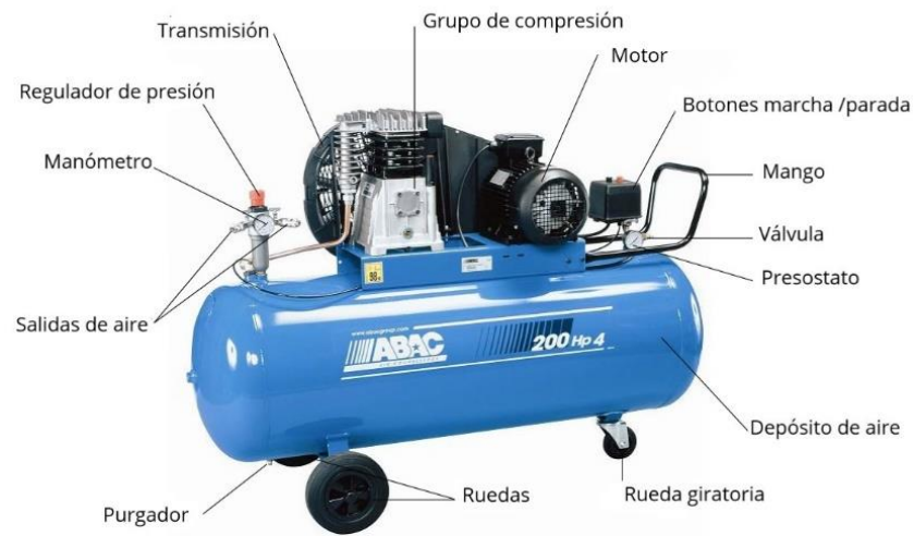
Figura 2. 2. Compresor tipo pistón Fuente: (José, 2020)
