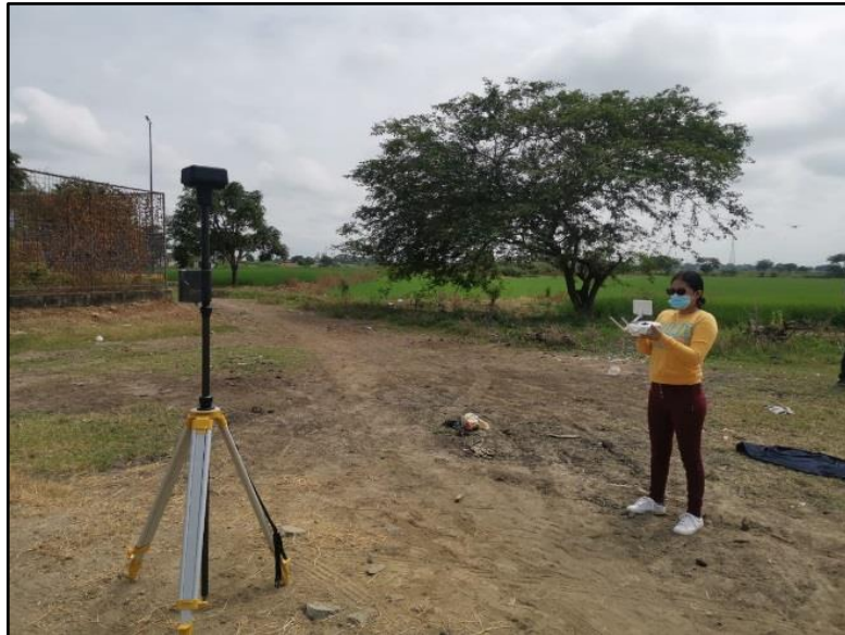
Ilustración 15. Levantamiento topográfico de la comunidad del Prado con Dron Paton RTK
