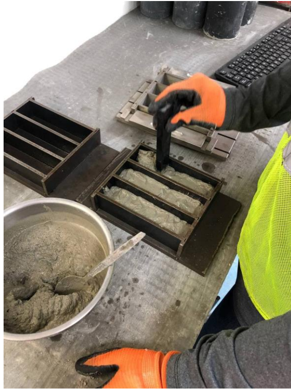
Ilustración 6 Proceso de elaboración de probetas, inserciones en la primera capa
