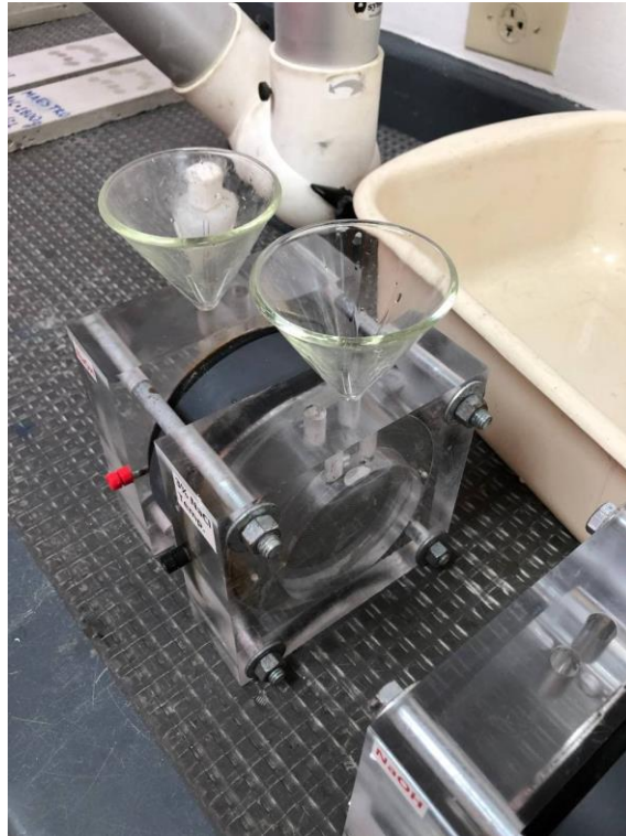
Ilustración 15 Colocación de las soluciones de NaOH y 3% NaCl
