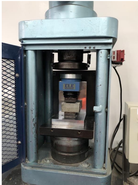
Ilustración 12 Muestra a realizar el ensayo de compresión
