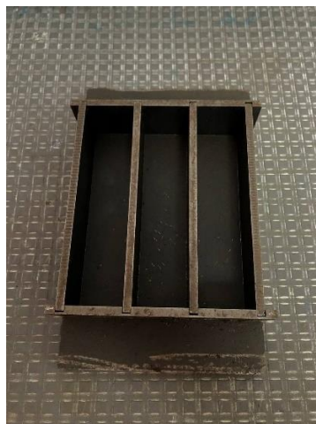
Ilustración 7 Molde para el ensayo de flexotracción
