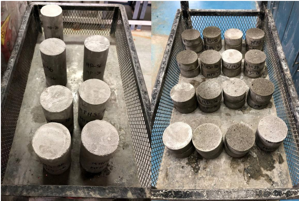
Ilustración 17 Cilindros antes y después de ser cortados
