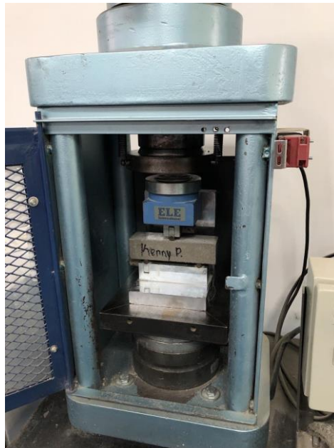
Ilustración 11 Muestra a realizar el ensayo de flexión
