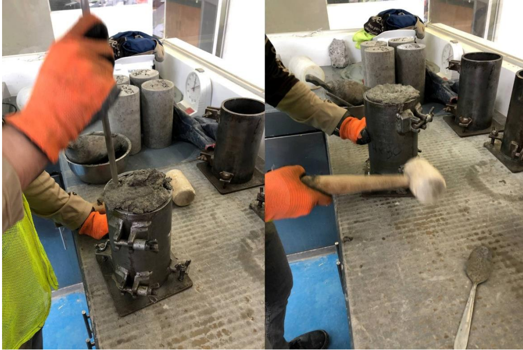
Ilustración 5 Proceso de elaboración de los cilindros, inserciones y golpes laterales
