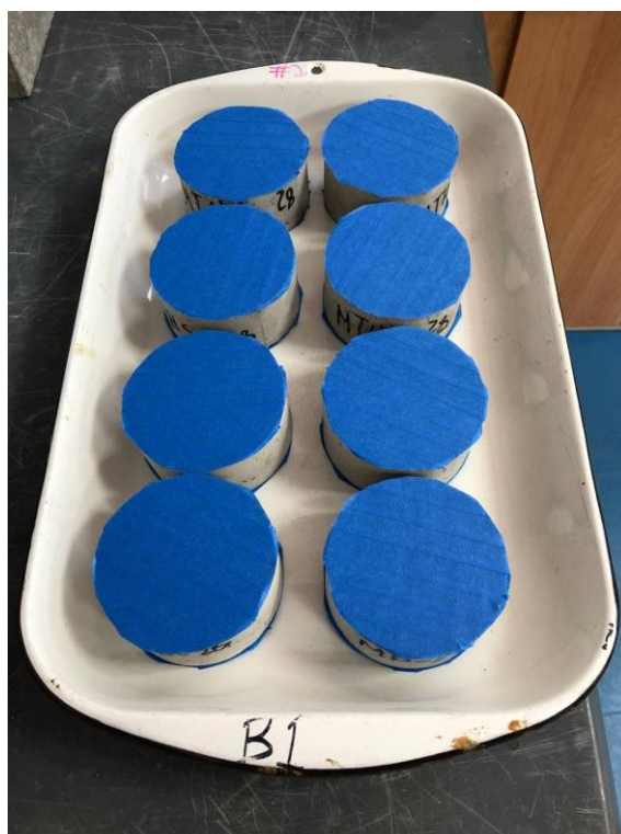
Ilustración 13 preparación de las muestras para la aplicación de silicona
