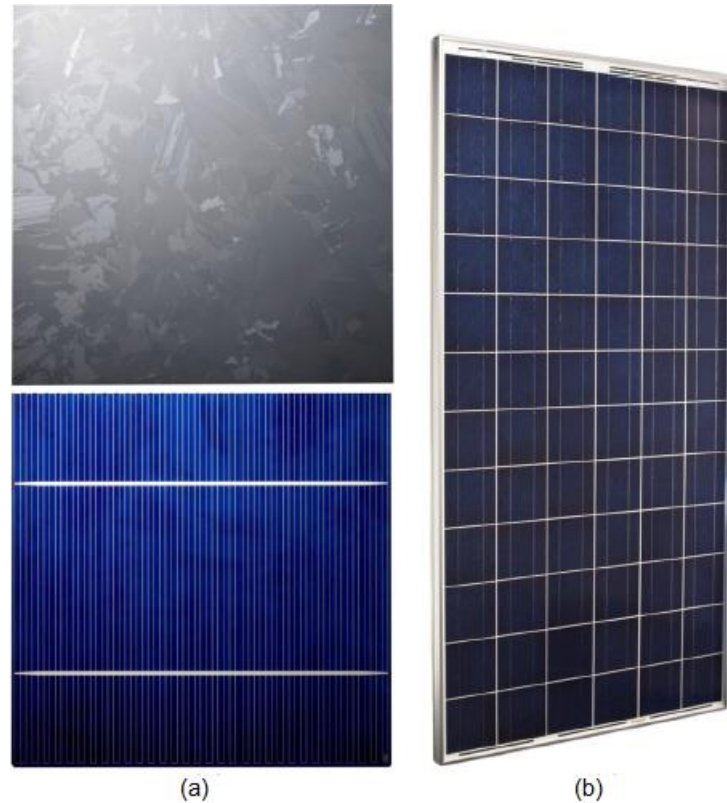
Figura 2.6: (a) Célula y láminas solares policristalinas de 156 mm; y (b) Módulo de células solares de 280 W (a partir de láminas policristalinas).
