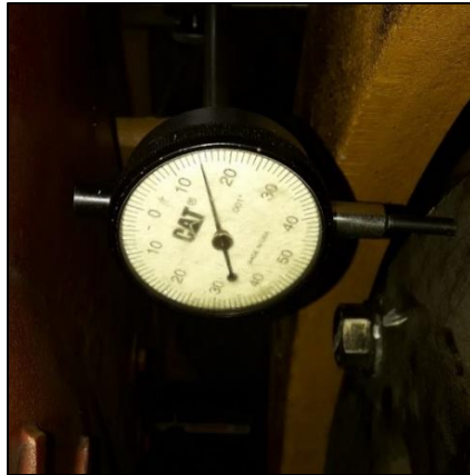
Figura 3. 14: Registro del juego axial del grupo electrógeno Elaborado por: Autor
