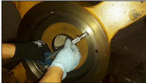
Figura 3. 12: Registro del diámetro del alojamiento del rodamiento Elaborado por: Autor
