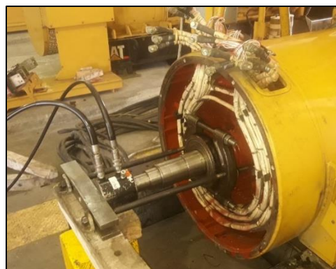
Figura 3.11: Extracción del rodamiento del eje Elaborado por: Autor
