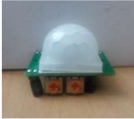
Figura 3-11: Potenciómetros para regular el sensor PIR
