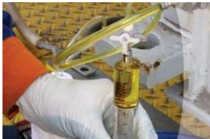
Figura 2-22: Análisis del aceite dieléctrico en un transformador Fuente: Cite Energía, 2019
