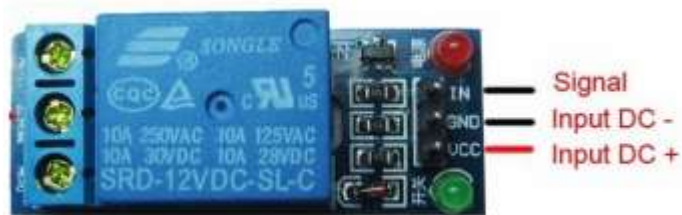
Figura 3-12: Conexiones del módulo relé
