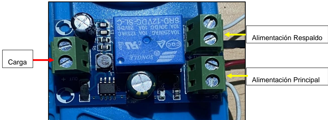
Figura 3. 1 Módulo interruptor automático de emergencia Fuente: Autor
