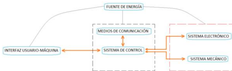
Figura 2. 4: Bloques de estructura pertenecientes a un robot móvil.
