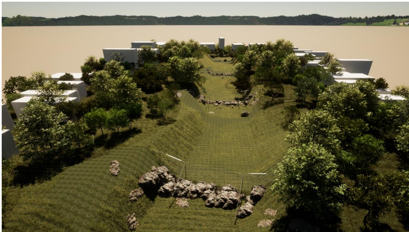
Figura 100 Vista esquemática de las defensas dinámicas sucesivas para flujo de detritos
