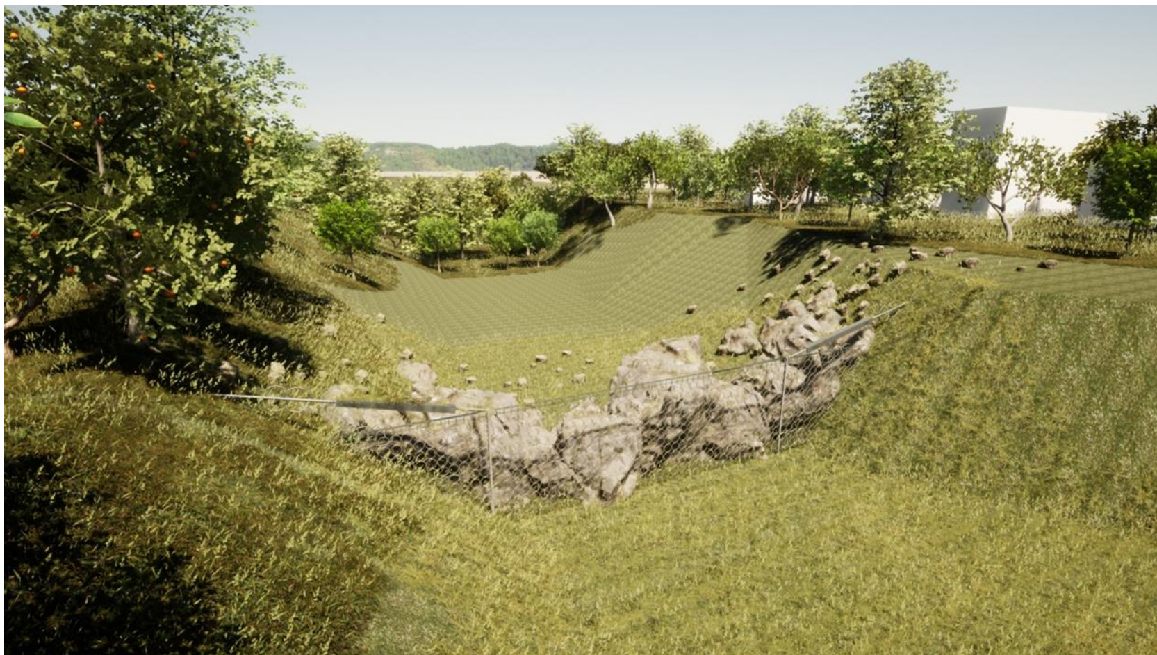
Figura 96 Vista esquemática de las defensas dinámicas sucesivas para flujo de detritos
