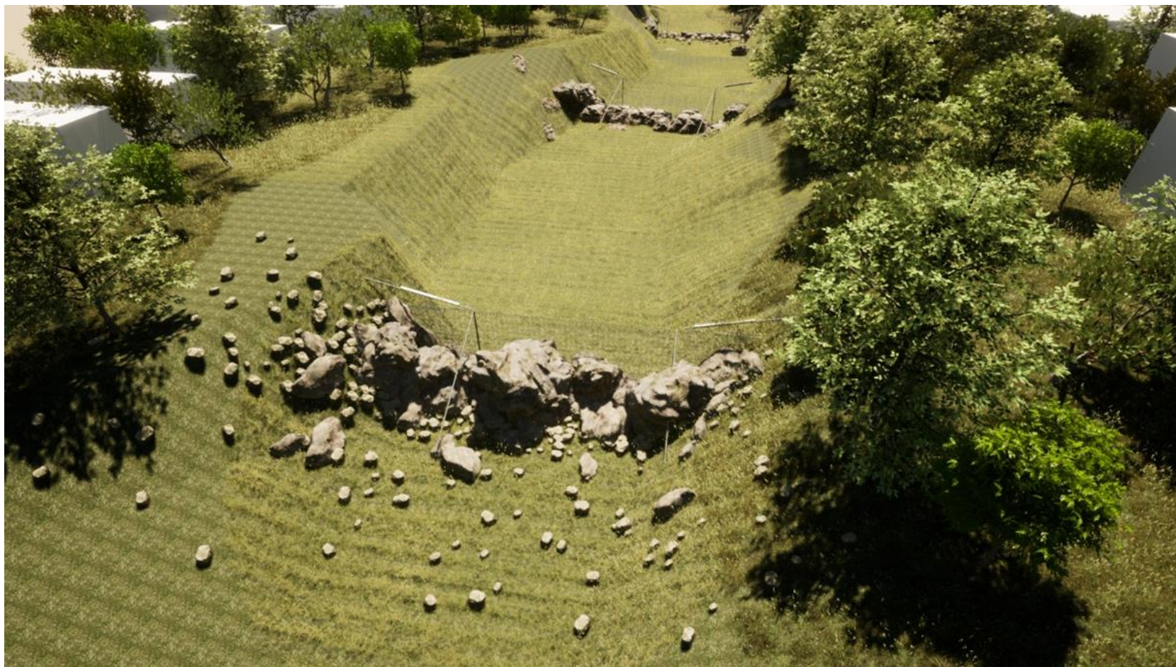
Figura 99 Vista esquemática de las defensas dinámicas sucesivas para flujo de detritos
