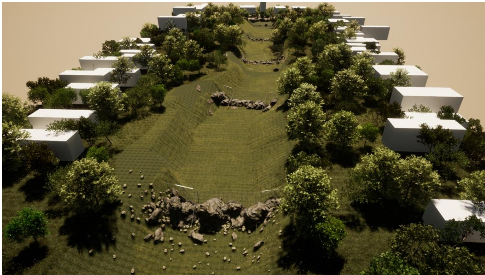
Figura 101 Vista esquemática de las defensas dinámicas sucesivas para flujo de detritos
