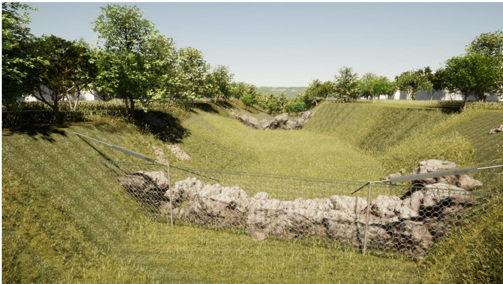
Figura 97 Vista esquemática de las defensas dinámicas sucesivas para flujo de detritos
