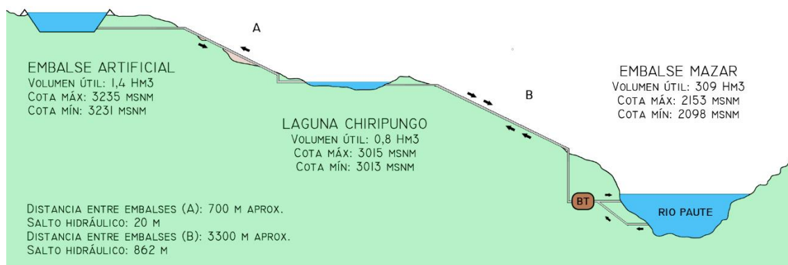
Ilustración 93. Esquema de variante de la propuesta 1 de la central hidroeléctrica reversible con conducción superficial. Fuente: autor
