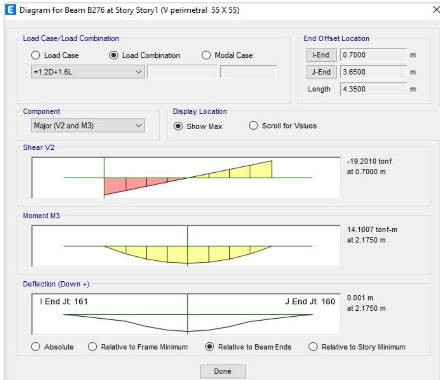
ANEXO 11: Diagrama de las fuerzas internas para la viga perimetral cargadora con una combinación 1.2D+1.6L en Etabs
