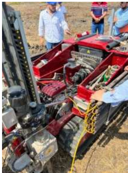
Ilustración 36. Sistema de hincado (Autoría propia)
