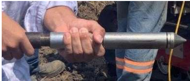
Ilustración 34. Cono para ensayo CPTu (Autoría propia)
