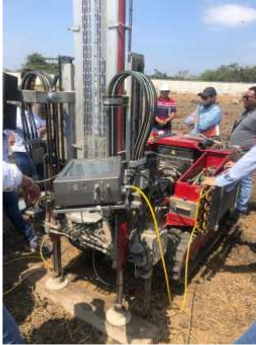
Ilustración 8. Equipo para el ensayo del piezocono. (Autoría propia)
