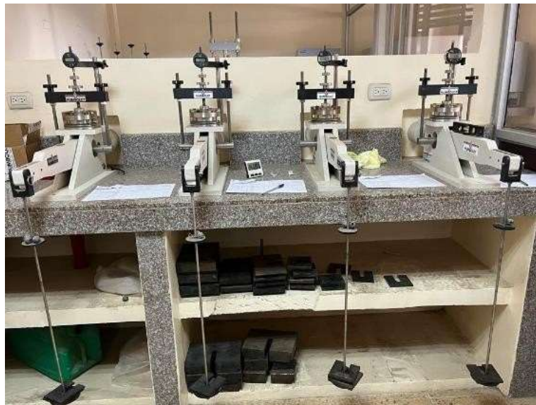
Ilustración 43. Cuatro ensayos de consolidación en simultáneo. (Autoría propia)
