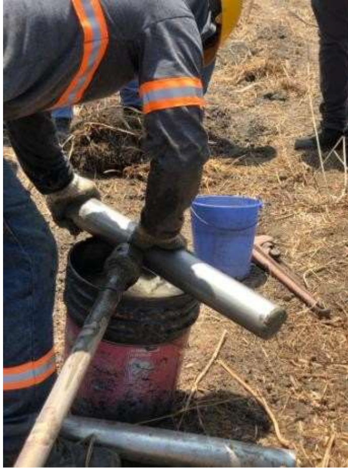
Ilustración 31. Ejemplar de muestra extraída con tubo Shelby. (Autoría propia)
