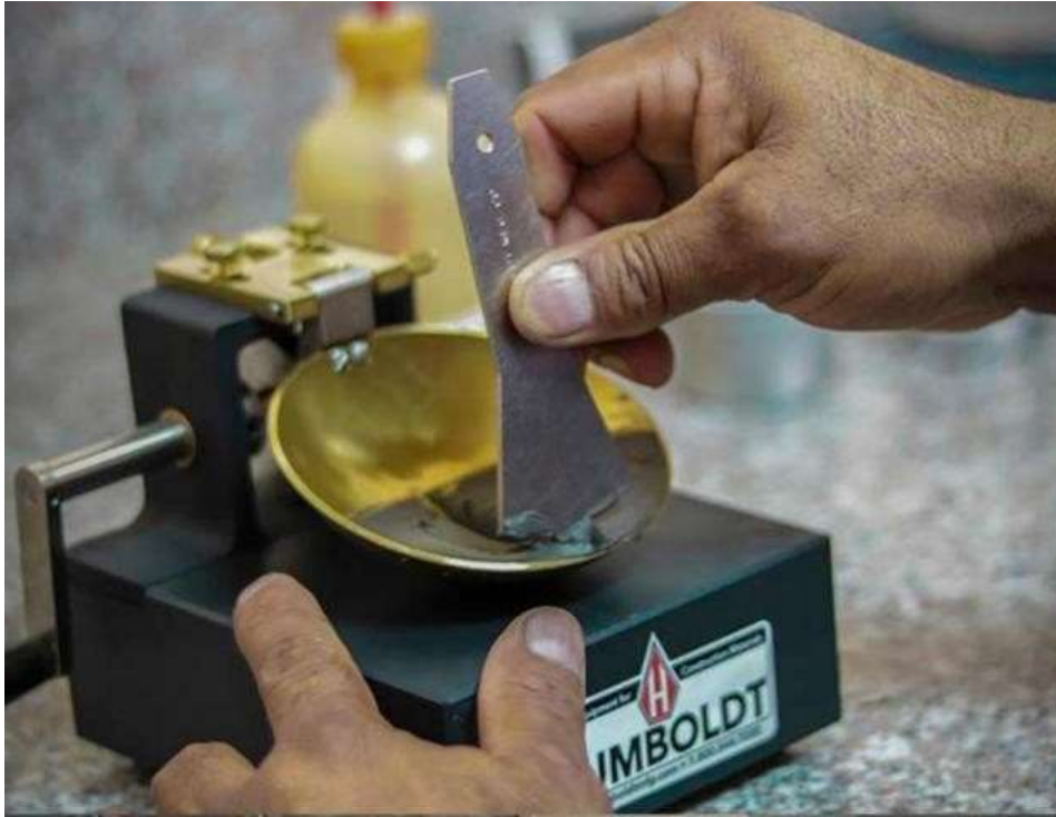
Ilustración 39. Ensayo de límite líquido usando la cuchara de Casagrande. (Autoría propia)
