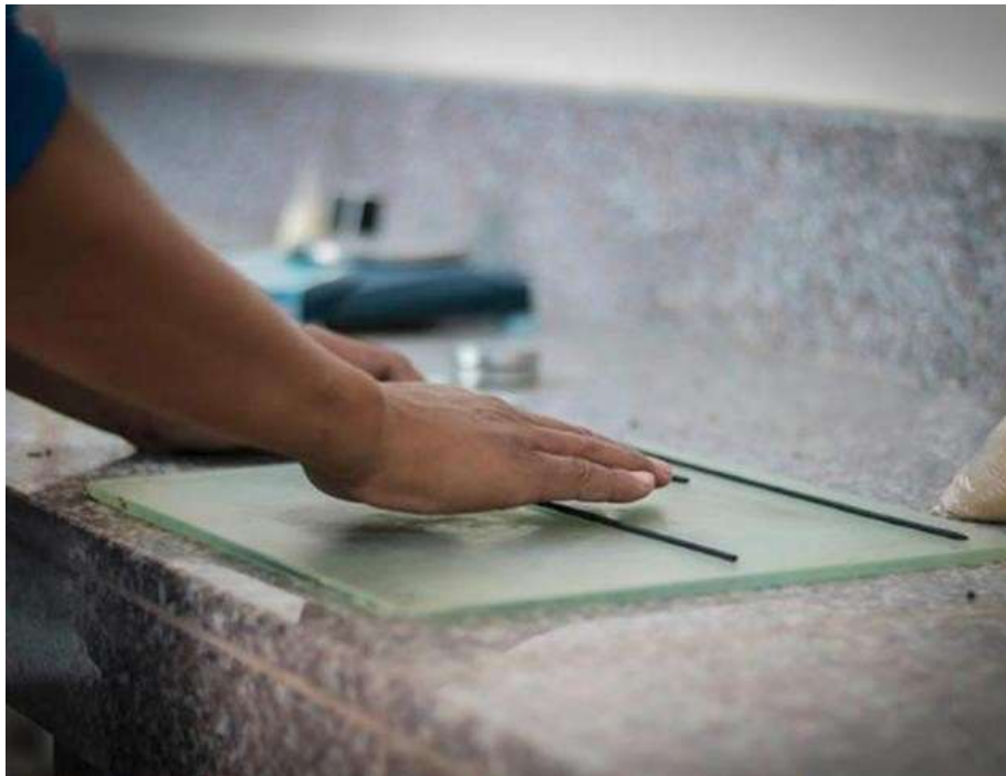
Ilustración 41. Ensayo límite plástico. (Autoría propia)
