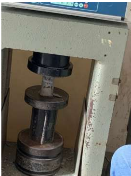
Figura 64. Rotura de probetas de lechada de cemento
