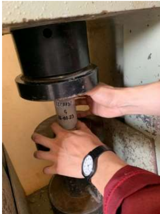
Figura 63. Rotura de probetas de lechada de cemento
