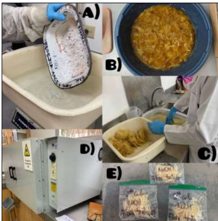
Ilustración 9. Proceso de tratamiento de Hidróxido de Sodio. (A) Solución de H_2O + NaOH , (B) Mezcla de solución con la fibra y reposo, (C) Lavado de fibra tratada, (D) Secado de la fibra tratada, (E) Sellado de fibra en bolsas herméticas. Fuente: Autor
