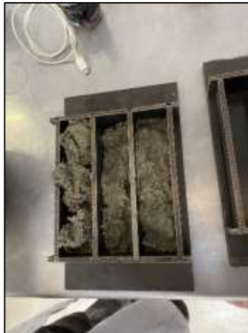
Ilustración 12: Fundición de moldes en 2 capas.
