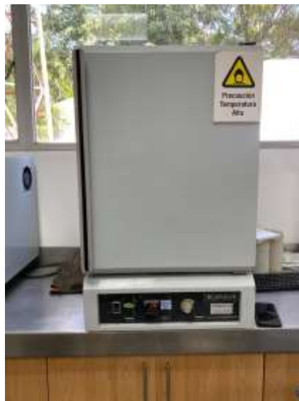
Ilustración 36: Probetas dentro del horno a temperatura de 70 °C.
