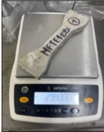
Ilustración 29: Lectura de masa de probetas para ensayo de tracción.
