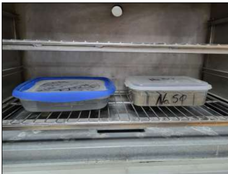
Ilustración 28: Proceso de humedecido para envejecimiento acelerado 1 (wet & dry). Fuente: Autor
