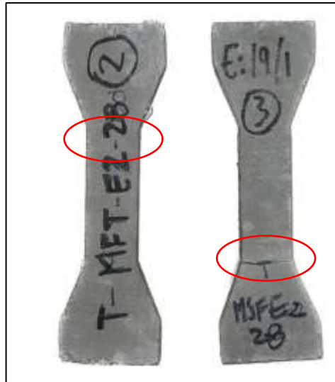
Ilustración 47. Fractura de las probetas sometidas a envejecimientos MFT (con fibra) y MSF (sin fibra) ensayadas a tracción. Fuente: Autor
