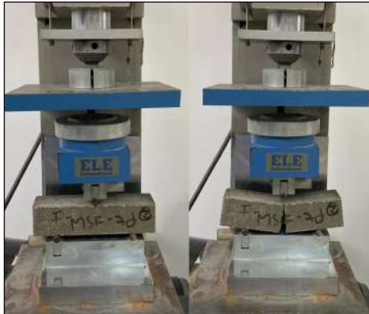
Ilustración 24. Proceso de ensayo de probeta a flexión.
