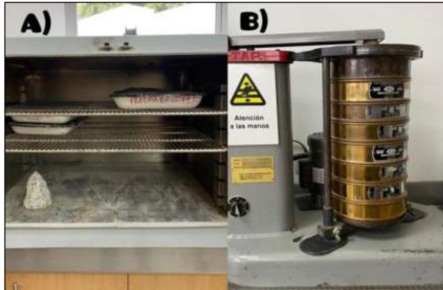
Ilustración 5. a) Arena en horno a 110 °C. b) Tamizadora.
