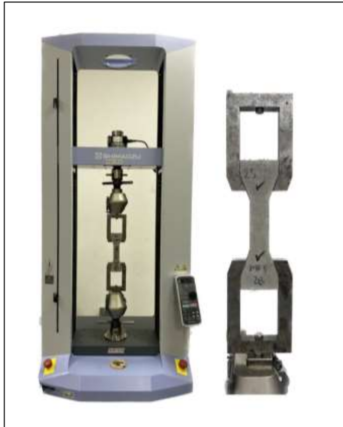
Ilustración 18. Máquina para ensayo a tracción a probeta dog bone.
