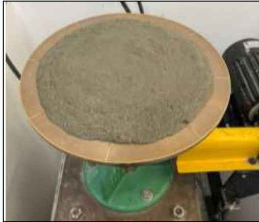
Ilustración 10: Mesa de flujo para verificar trabajabilidad del mortero.
