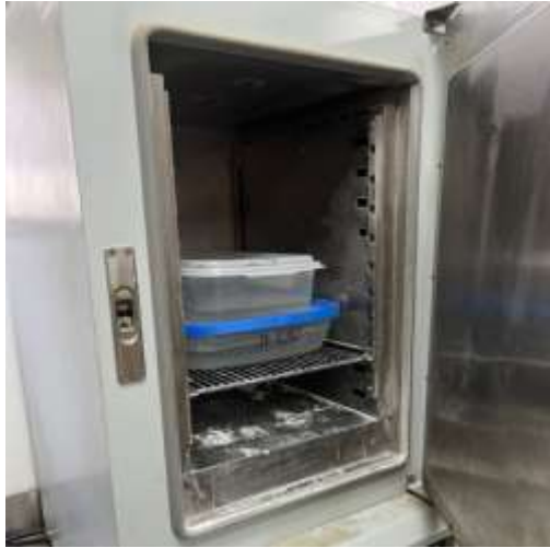
Ilustración 35: Bandejas con agua sellada, introducidas a un horno a temperatura de 70 °C.
