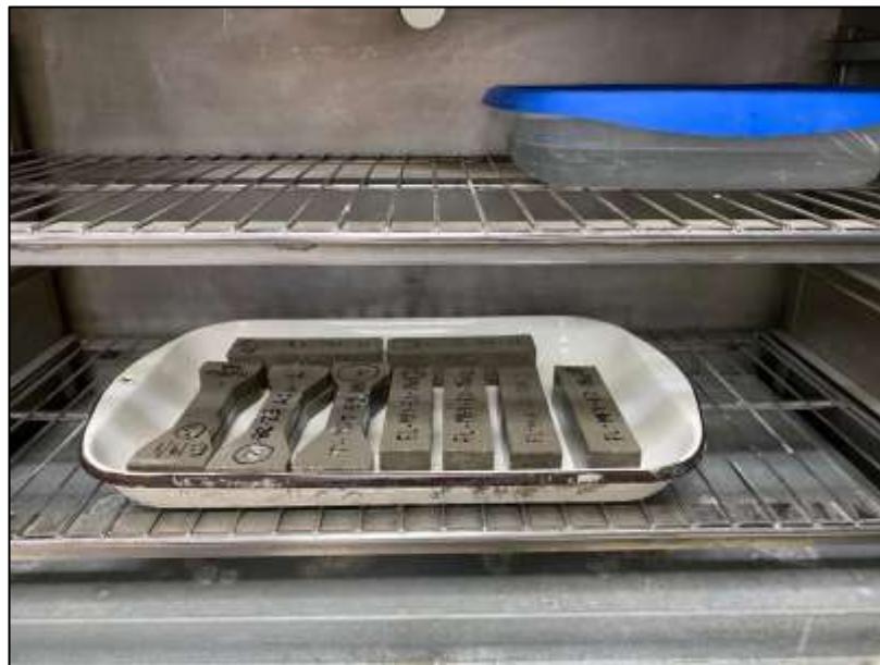
Ilustración 30: Proceso de secado para envejecimiento acelerado 1 (wet & dry). Fuente: Autor
