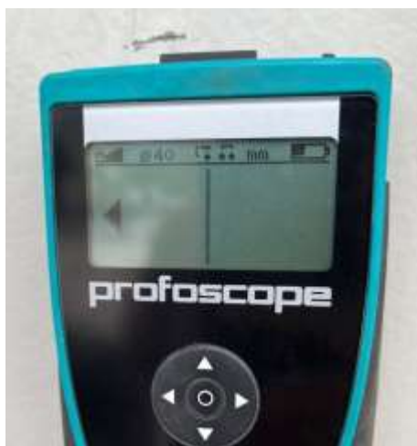
Figura 26 Instrumento Profoscope haciendo lectura, indicando que el acero se encuentra a la izquierda. Fuente: Propio.
