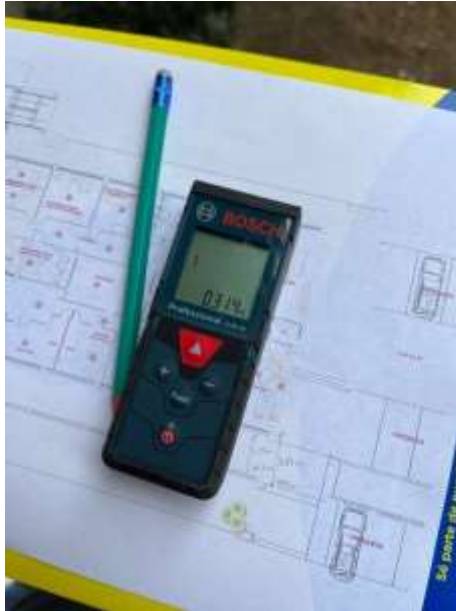
Figura 17 Laser BOSCH GLM 40 Professional. Fuente: Propio.
