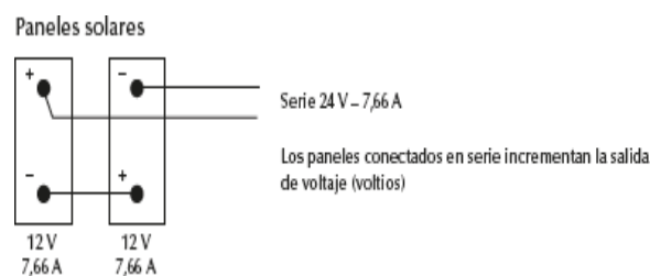
Figura 9 Conexión de paneles en serie.
