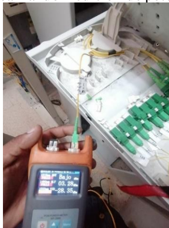
Figura 2.16: Power Meter realizando medición de potencia en las salidas de la OLT
