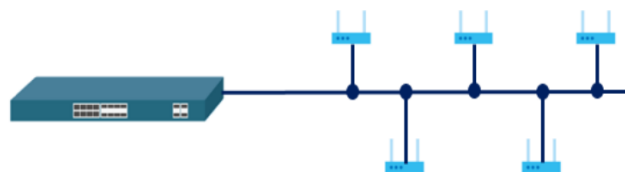
Figura 2.3: Arquitectura punto a multipunto
