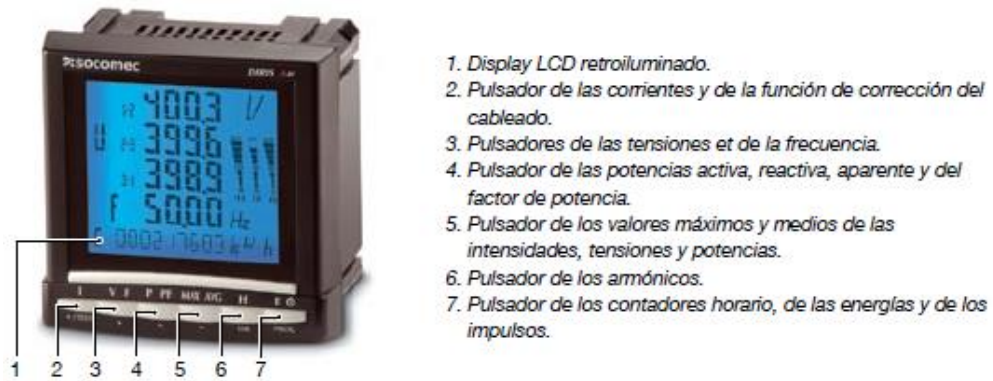
Figura 5 Componentes del medidor de energía Diris.
