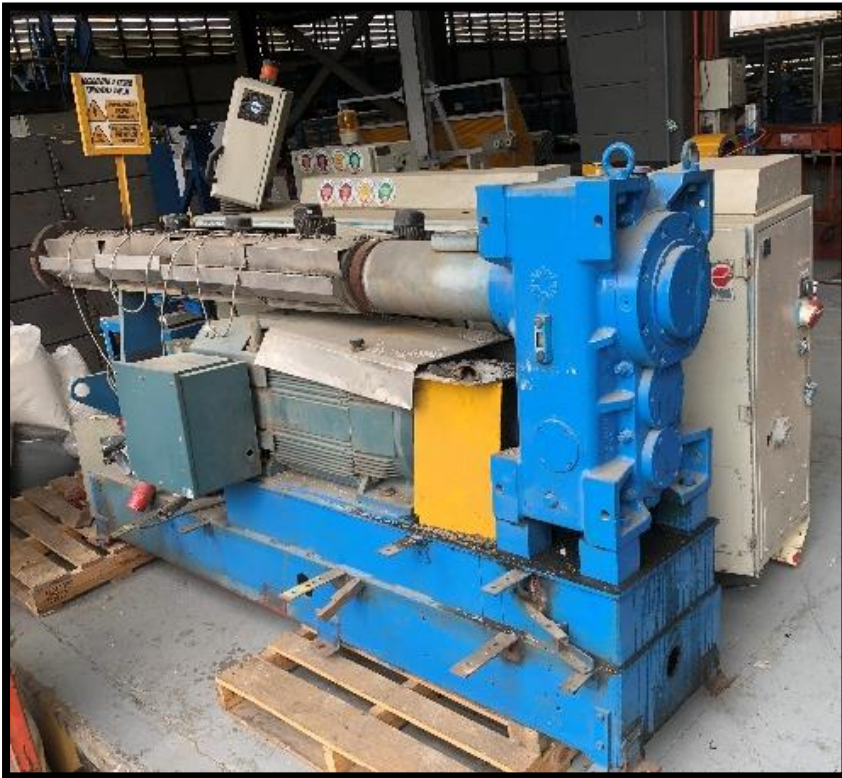
Figura 3. 4. Máquina de extrusión antigua usada en la subárea de extrusión. Fuente: Los autores.
