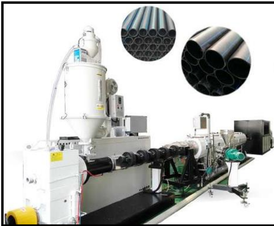
Figura 2. 19. Máquina de extrusión de mono husillo aplicado en tuberías polietileno. Fuente: (Industrial Sourcing, 2021).
