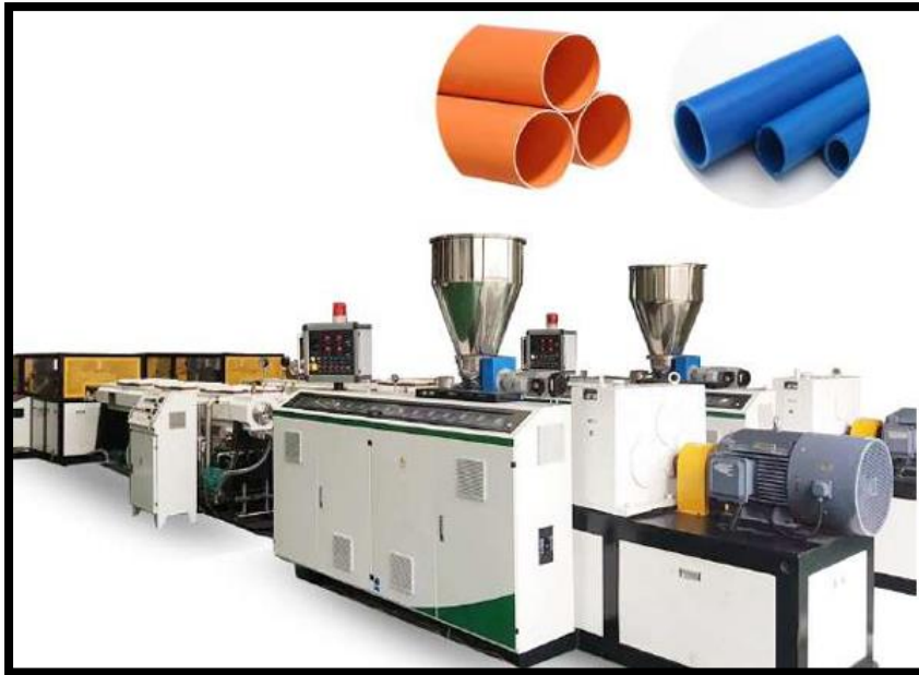
Figura 2. 20. Máquina de extrusión de doble husillo aplicado en tuberías de doble PVC. Fuente: (Industrial Sourcing, 2021).
