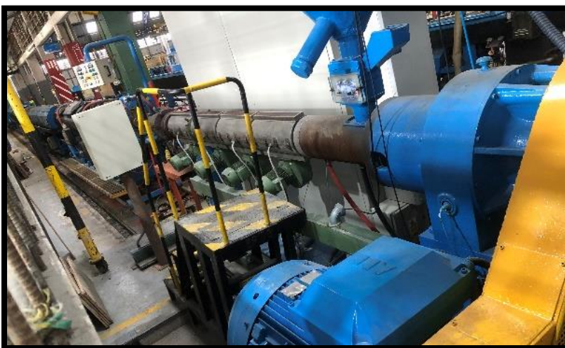
Figura 3. 6. Vista posterior de la máquina extrusora nueva y su motor principal. Fuente: Los autores.
