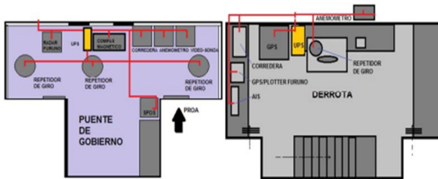
Figura 4.10: Redes de cableado de la Guardacostas
