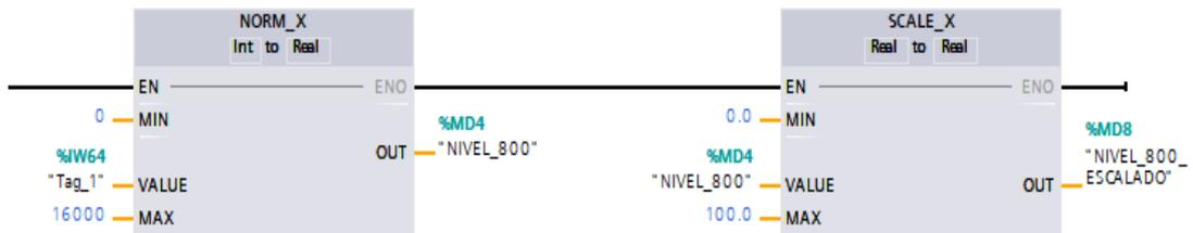
**Figura 3. 19:** Bloques de PLC para uso de señales analógicas.
