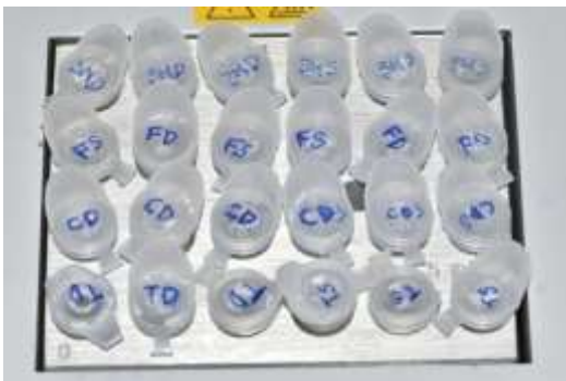
Ilustración 5 Los tubos de ensayo con los discos de resina en su interior en la máquina de termociclado
