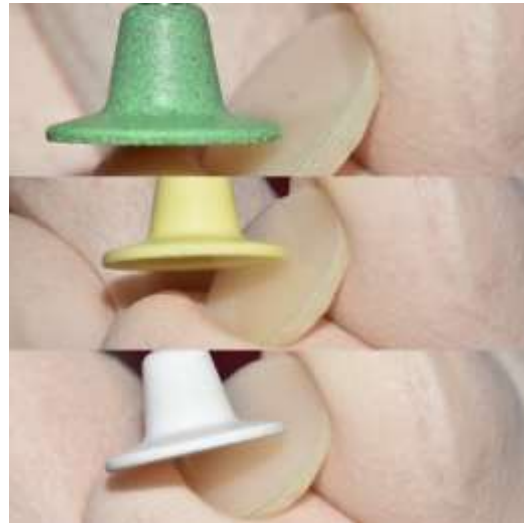
Ilustración 4 Pulido de los discos de resina con disco de goma
