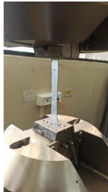
Figura 66 Ensayo de tracción. Alarcón, 2022
