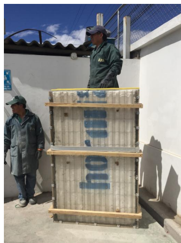
Figura 58 Ensayo de mortero proyectado. Fuente: Orozco & Puente, 2016
