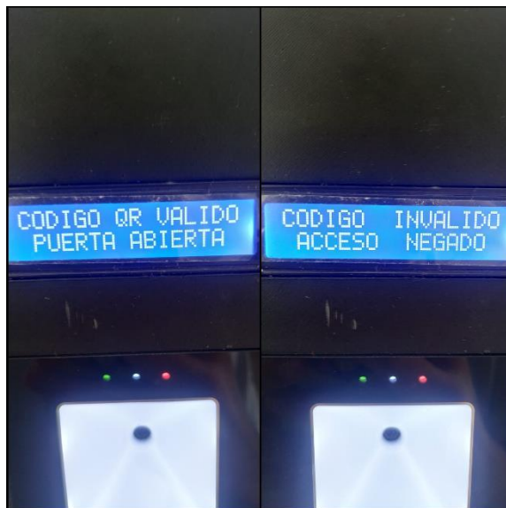
Figura 45 - Mensajes de acceso permitido(izq.) o denegado(der.) en dispositivo de acceso
