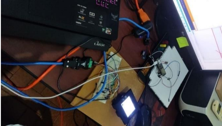
Figura 27 - Cambio de conexión con módulo ESP32 Lilygo
