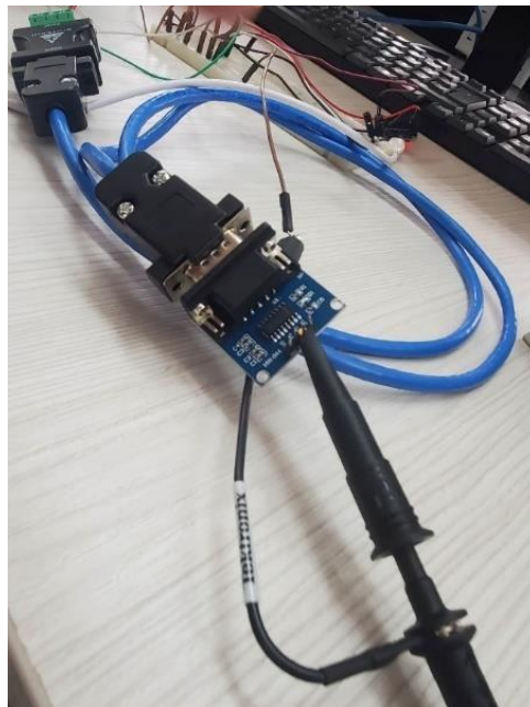
Figura 24 - Prueba de paso de corriente en Módulo RS 232/TTL (1)
