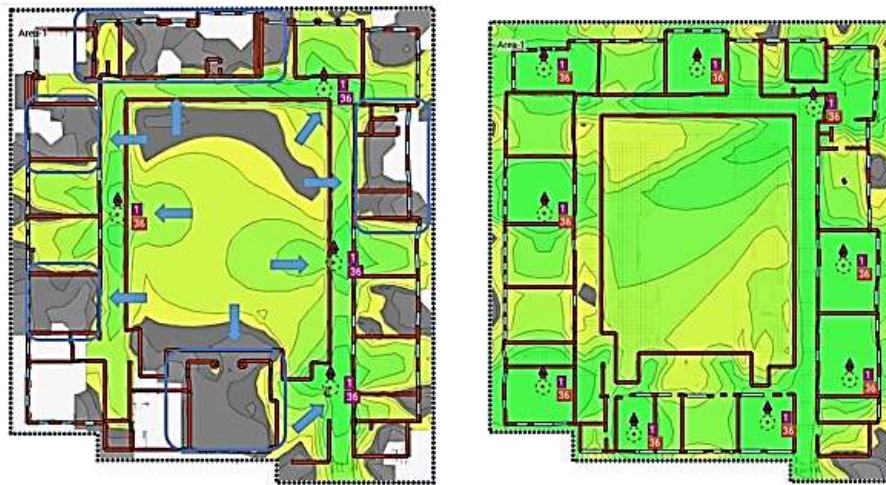
Figura 4.38. Comparación de FAD Tercer Piso (Edificio #1)
