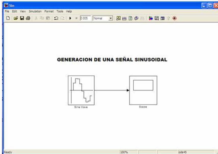
Figura 3.18. Ejemplo de generación de una señal sinusoidal. Fuente: Print Screen del Programa MATLAB/SIMULINK
