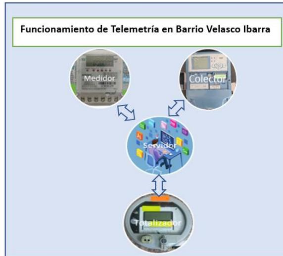
Nota: La figura nos muestra el sistema de alimentación de información de telemetría se recepta la información del medidor del usuario alimenta al totalizador, este a su vez alimenta al colector y este al servidor de la comercializadora. Fuente: Endo Sánchez, Jaime Nicolás, Ochoa Miranda, Jhonny Omar
