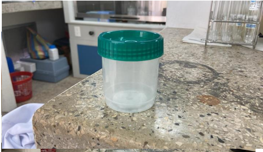
Ilustración 11. Recipiente para recoger muestras de coliformes fecales. Fuente: Autor.
