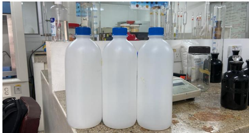
Ilustración 10. Botellas resistentes de muestreo para recoger el agua residual. Fuente: Autor.
