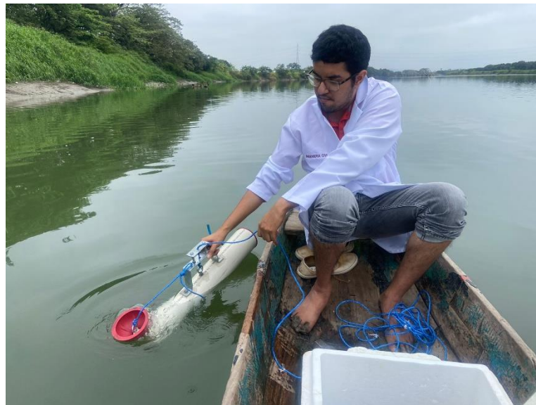
Ilustración 22. Toma de muestra en Río Daule con Botella Van Dorn. Fuente: Autor.
