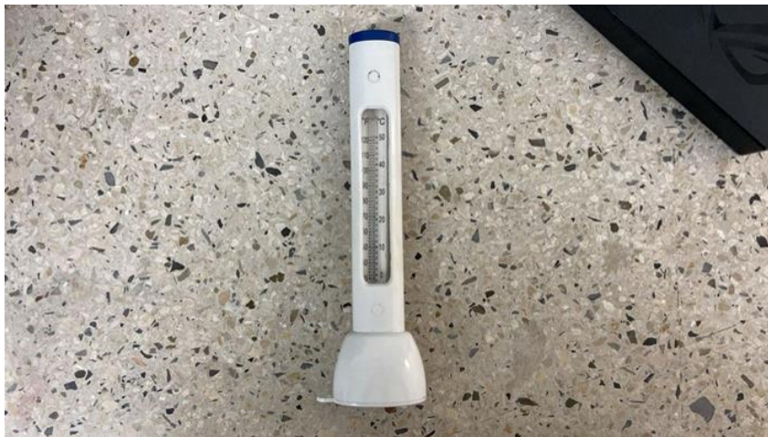
Ilustración 12. Termómetro para medir la temperatura en sitio. Fuente: Autor
