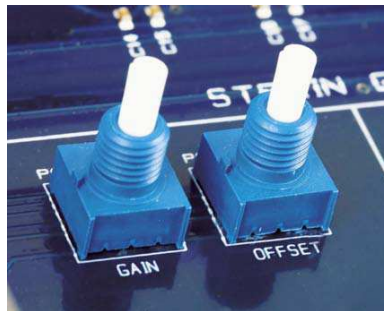
Figura # 50: Potenciómetros de ganancia y de Compensación (Offset) del módulo Qnet Fuente: Guía práctica de control Quaser
