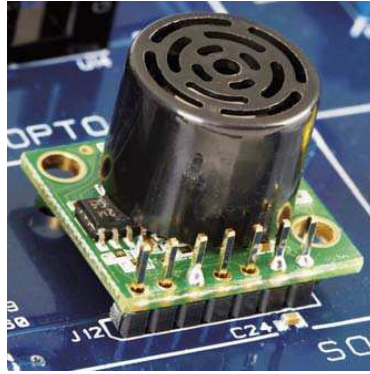
Figura # 51: Sensor sonar del módulo Qnet Fuente: Guía práctica de control Quaser
