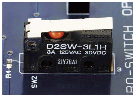
Figura # 55: Micro switch utilizado en el módulo Qnet Fuente: Guía práctica de control Quaser
