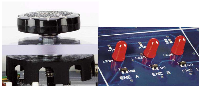
Figura # 46: Encoder giratorios y Encoder Led del módulo Qnet Fuente: Guía práctica de control Quanser
