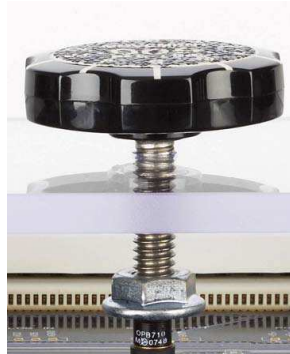
Figura # 53: Sensor óptico de posición (abajo) y el objetivo mando de posición (arriba) en el módulo QNET.
