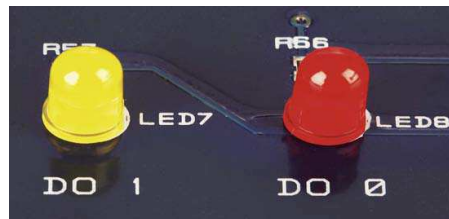
Figura # 58: Diodos emisores de Luz utilizados en el módulo Qnet Fuente: Guía práctica de control Quaser
