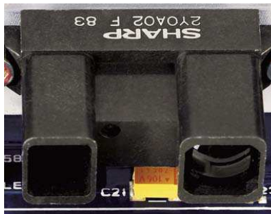
Figura # 52: Sensor Infrarrojo del módulo Qnet Fuente: Guía práctica de control Quaser
