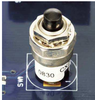
Figura # 56: botón pulsador utilizado en el módulo Qnet Fuente: Guía práctica de control Quaser
