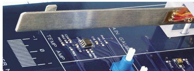
Figura # 43: Sensor Galgas extensiométricos (Strain Gages) del módulo Qnet Fuente: Guía práctica de control Quanser
