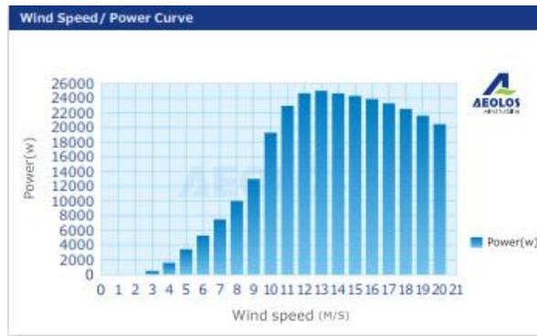
Figura 4.5 Curva de potencia vs velocidad
