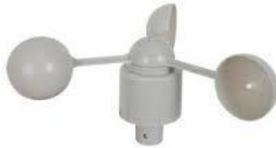
Figura 2.9 Anemómetro de cazoletas
