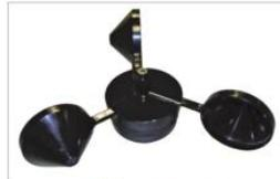
Figura 1. Anemómetro de cazoletas
