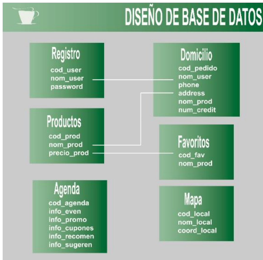
Ilustración 29: Diseño de la base de datos del aplicativo móvil.
