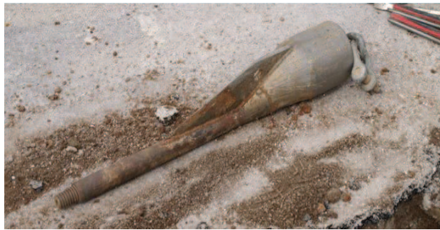
Imagen 9. CABEZA CÓNICA CON CUCHILLA
