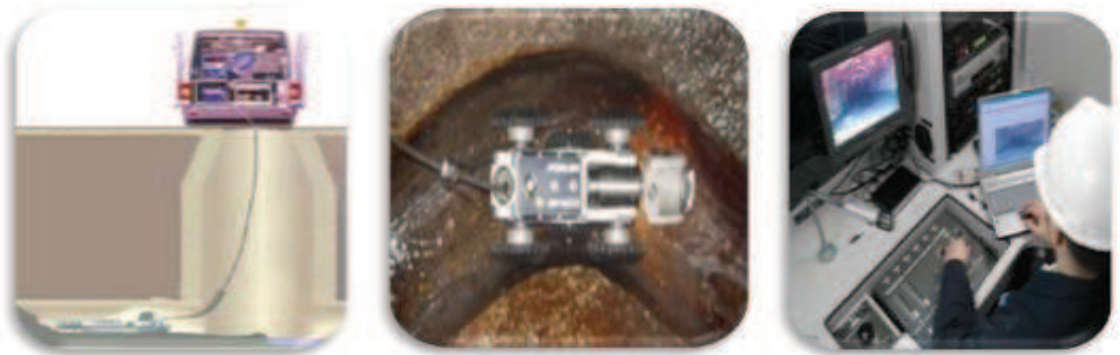
Ilustración 18. EQUIPOS PARA INSPECCIÓN CON CCTV.
