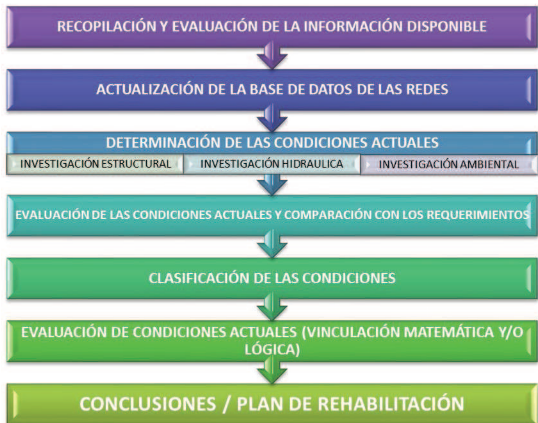
Ilustración 11. METODOLOGIA GENERAL PARA EVALUACION DE CONDICIONES ACTUALES DE UN SISTEMA. (Stein, 2001)
