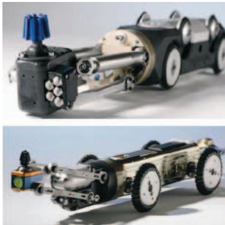
Imagen 5. . Robots de fresado hidráulico y nemático. Fuente: Tec-san catálogos
