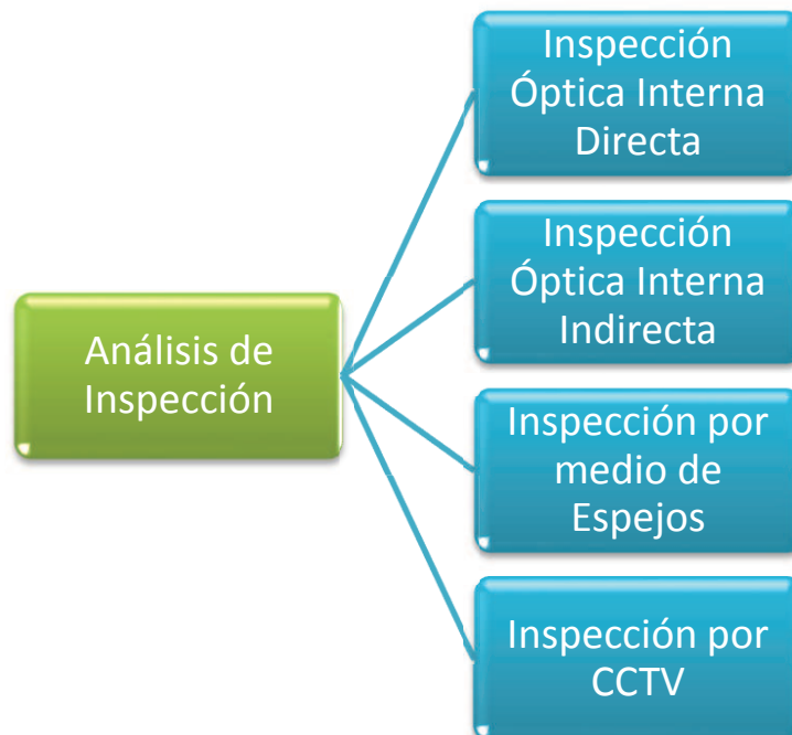
Ilustración 16. METODOS PARA INSPECCIÓN EN TUBERÍAS (Stein, 2001)
