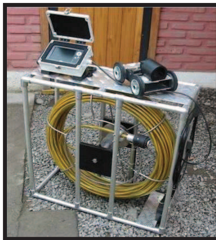
Ilustración 17. EQUIPOS PORTÁTILES ACOPLADOS PARA INSPECCIÓN DE CÁMARAS.
