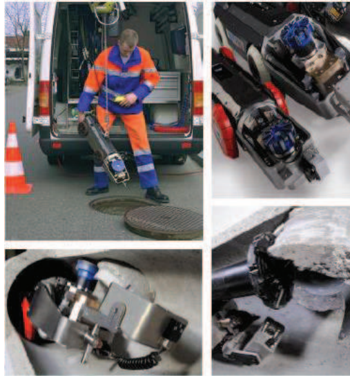
Imagen 4. Robots Multifunción. Fuente: Tec-san catálogos
