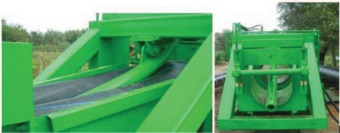
Imagen 19. Máquina para doblado del PEAD en sitio.
