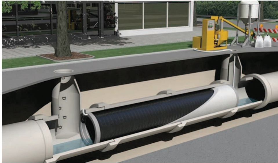
Imagen 23. Relleno con mortero en espacio entre tubo viejo y nuevo.
