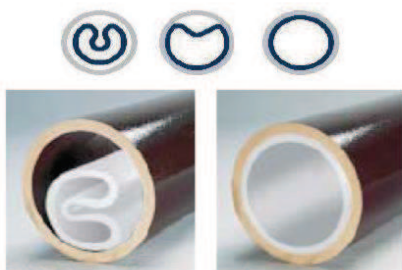
Imagen 18. Proceso de recuperación del PEAD en técnica de Close Fit.
