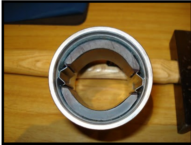
Figura 2.4 Inductor de imanes permanentes del motor de corriente continua. Fuente: Electricidad (2014).
