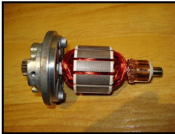
Figura 2.5 Rotor de un motor de imán permanente. Fuente: Electricidad (2014).
