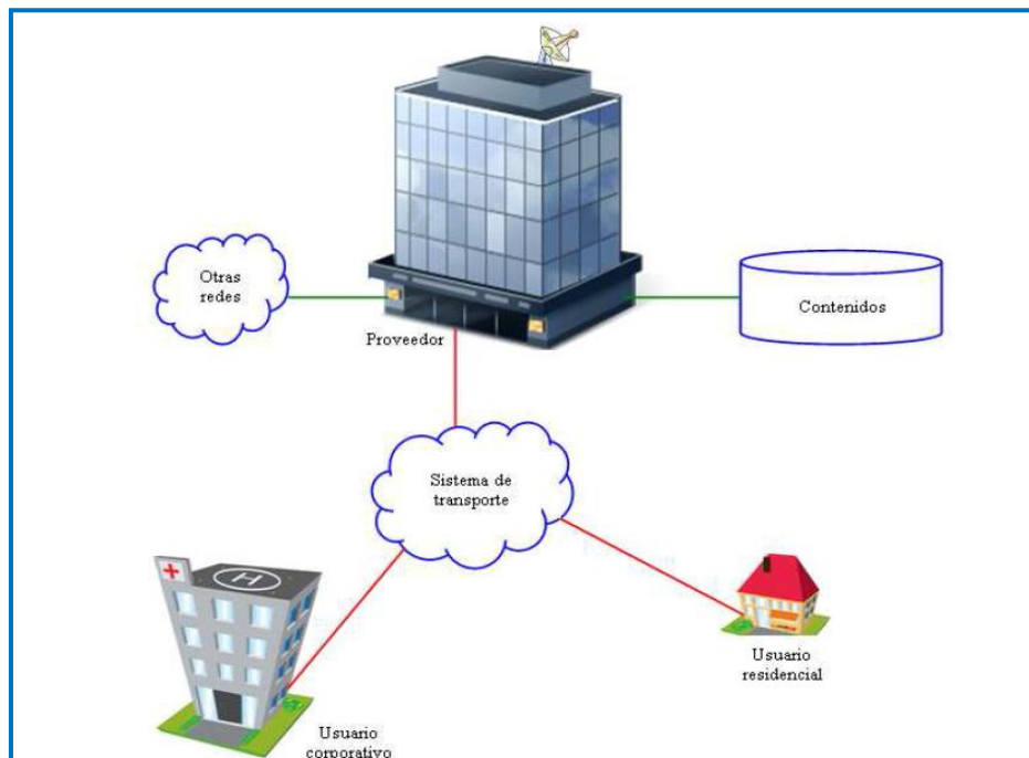
Figura 2: “Red de telecomunicaciones vista en bloque”
