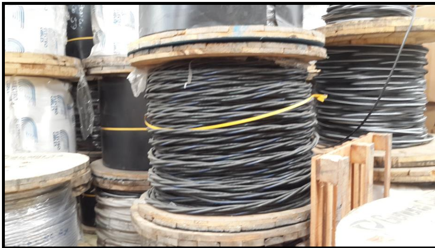
Figura 25. Cable concéntrico 3x 6 de cobre utilizado para acometidas Fuente: Fotografía Rainier Romero
