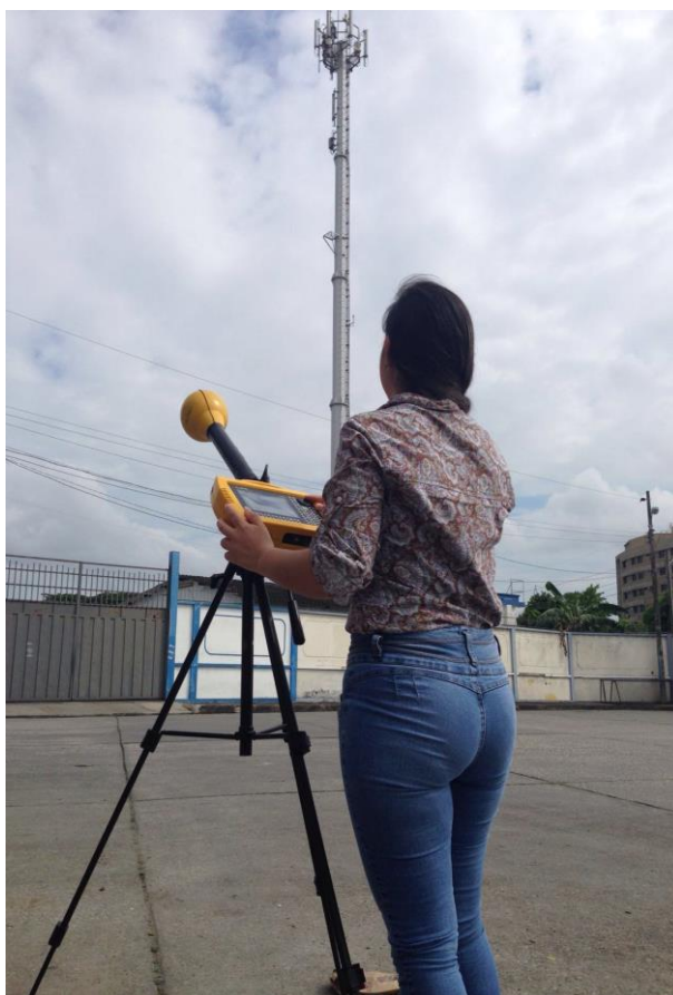
Figura 3. 8: Mediciones con el equipo NARDA SRM 3000
