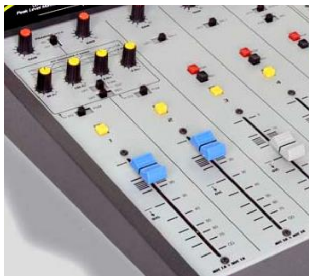
Figura 3. 5: Ecualizadores de los 4 canales para micrófono
