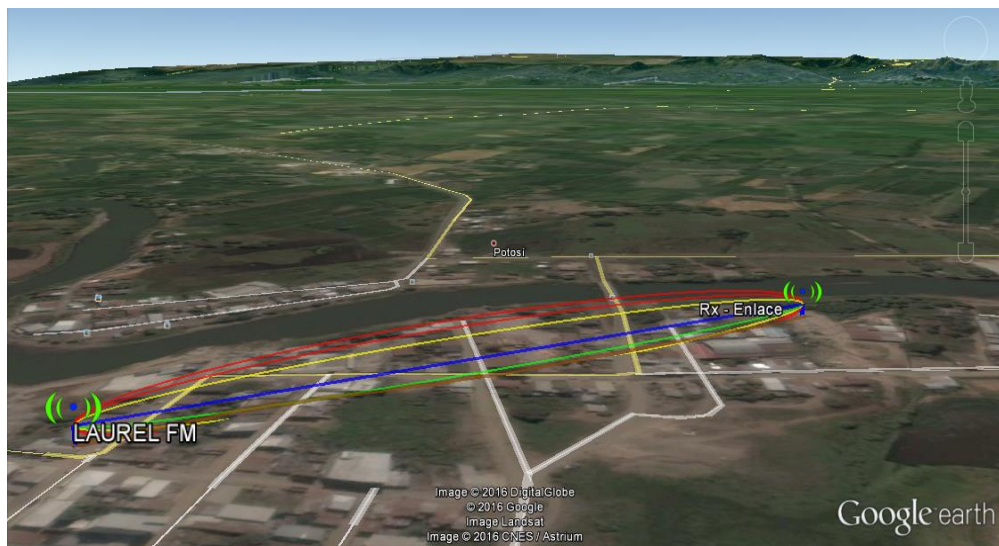
Figura 3. 18. Simulación radioenlace Estación matriz – Torre Estación Junta Parroquial
