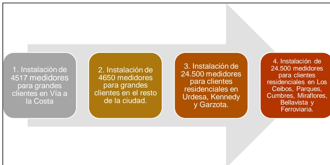
Figura 24. Etapas de instalación de los medidores inteligentes
