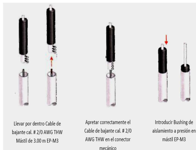
Fig. 3. 6 Proceso de armado de pararrayos Dipolo
