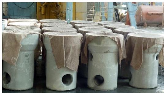
Figura 21: Cajas domiciliarias fabricadas de hormigón Fuente: Compañía dedicada a la fabricación de productos de hormigón
