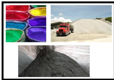
Figura 12: Colorantes minerales, piedra caliza y cenizas volantes como aditivos usados en el hormigón Fuente: La web www.quimicaviva.qb.fcen.uba.ar , www.laroca.com.gt , www.laroca.com.gt
