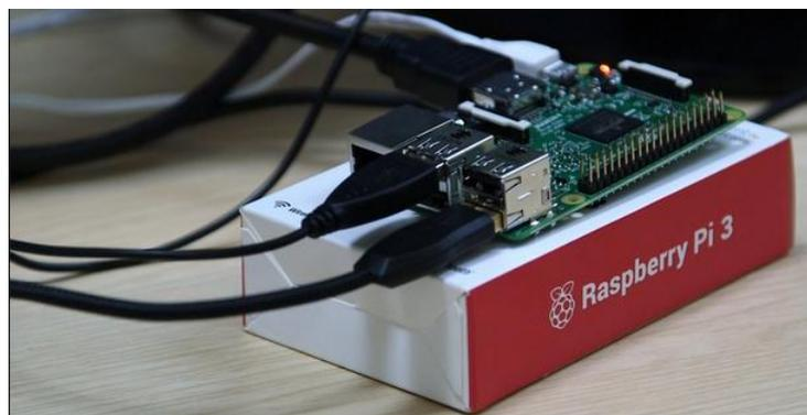
FIGURA 4. 1 : Módulo Raspberry Pi 3 MB
