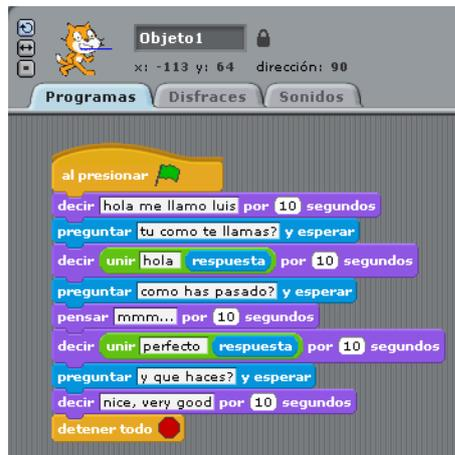
FIGURA 4. 16: Programación del gato para realizar el diálogo con el usuario
