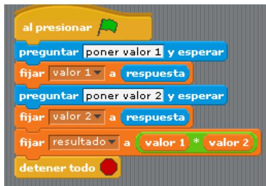
FIGURA 4. 33: Programación de la multiplicación entre dos valores y el resultado
