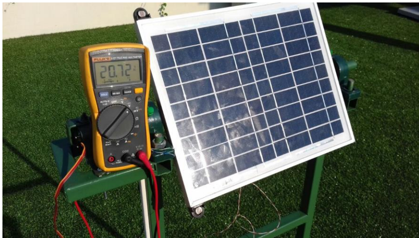
Figura 3. 15: Prueba del panel solar. Fuente: Elaboración propia.
