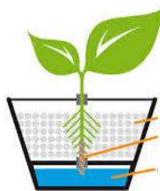
Figura 2. 3: Hidroponía mecha o pabilo Fuente: (Paye, 2012)
