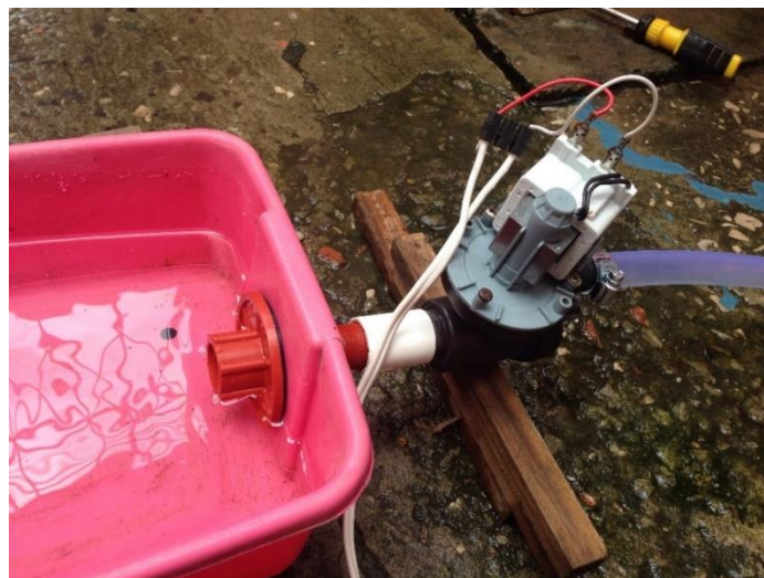
Figura 3. 24: Prueba de funcionamiento de la bomba de agua Fuente: Elaboración propia
