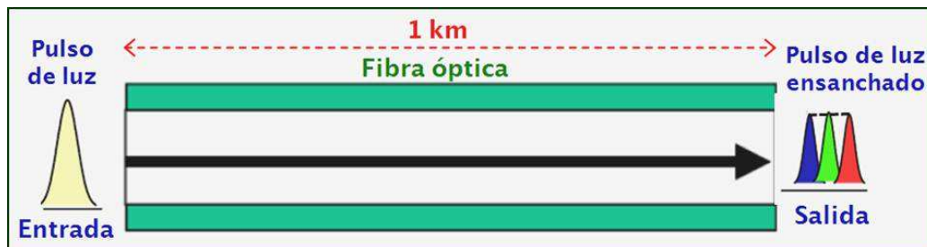
Figura 2. 14: Ancho de banda de una fibra SM, donde el pulso de luz se ensancha. [1]
