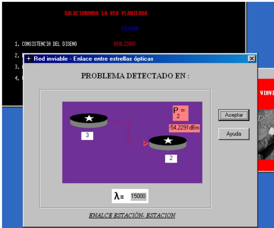
Figura 3. 26: Notificación del problema detectado en una PON.
