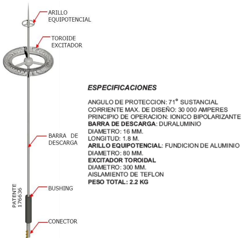
**Figura 4.1. Pararrayo Tipo Dipolo instalado en la Facultad Técnica para el Desarrollo**
