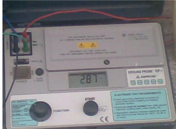
***Figura 5.1. Instrumento de Medición (Ground Probe GP-1) usado en la prueba de Resistividad del Terreno para la colocación de Malla Tierra del Pararrayos***
