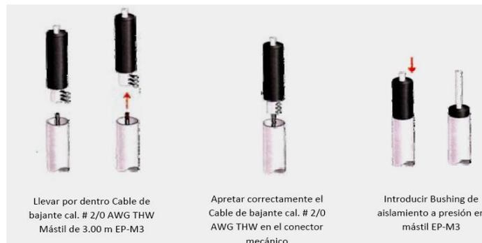
**Figura 4.5. (b) Especificación de las conexiones usadas para la conducción del cable 2/0 AWG del Pararrayos Tipo Dipolo**
