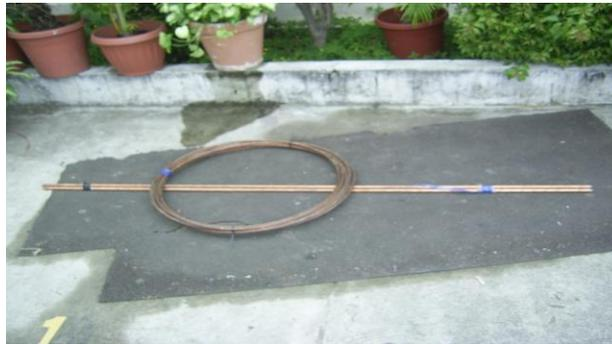
*Figura 6.5.2. (a) Varilla Copperweld usada para la implementación en las Salas de Cómputo*
