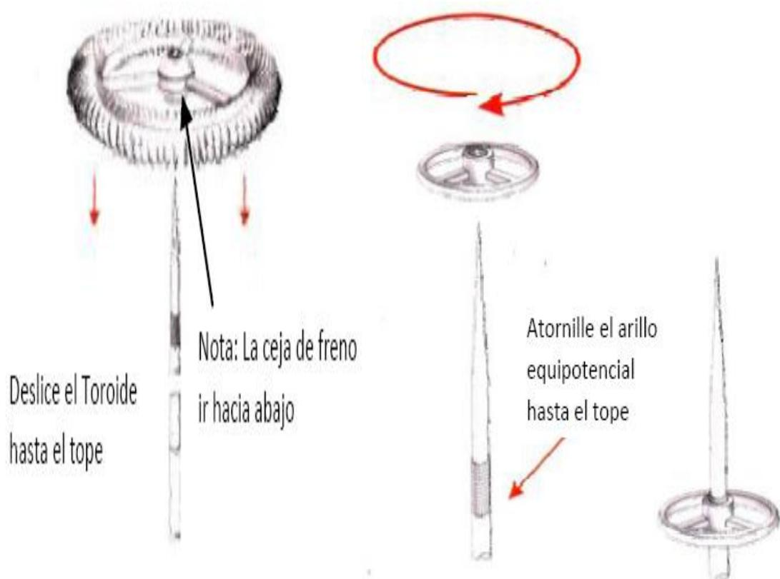
**Figura 4.5. (a) Especificación del Toroide Excitador y el Anillo Equipotencial del Pararrayos Tipo Dipolo**
