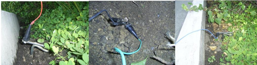
*Fig. 8.5.3. Colocación de jabalinas para aplicación de método de Wenner*
