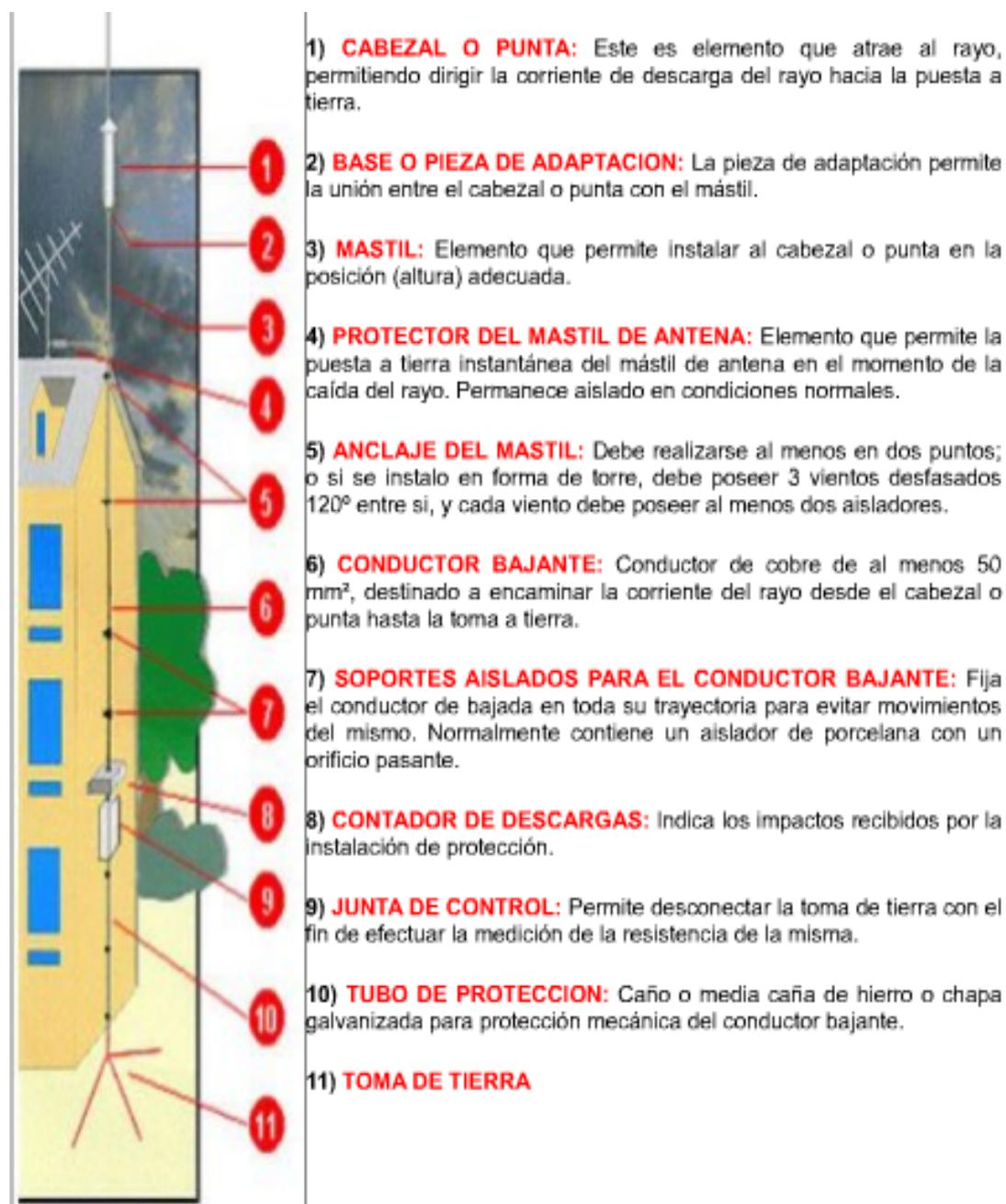
*Figura 3.2. Partes Principales de la instalación del Pararrayos implementado en la Facultad Técnica para el Desarrollo.*
