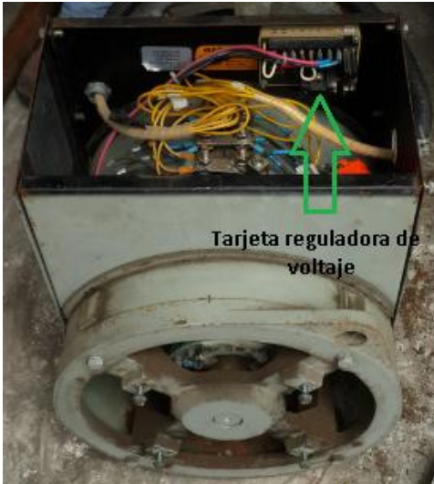
Figura 2.5 Tarjeta reguladora de voltaje El autor 2016
