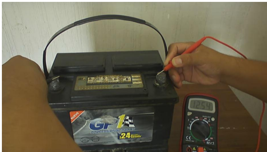
Figura 3.4 Medición de tensión entre bornes El autor 2016
