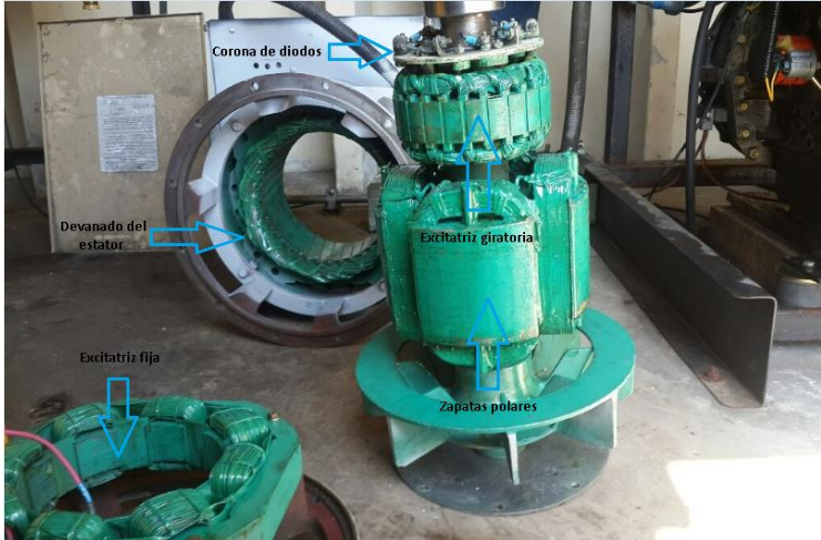
Figura 2.4 Partes principales del grupo electrógeno del Generador MAGNAPLUS El autor 2016
