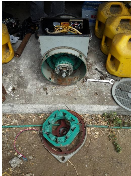
Figura 3.11 Separación del campo fijo El autor 2016
