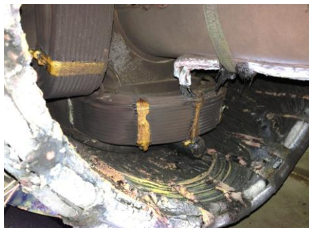
Figura 2.31 Zapatillas polares quemadas Fuente: libro de los mecánicos 2005
