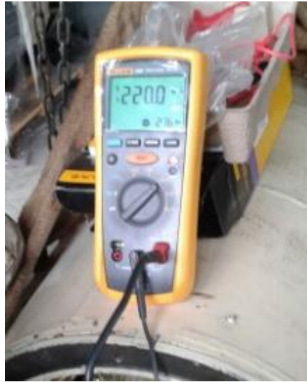
Figura 2.30 Toma de mediciones del aislamiento Fuente: El autor 2016
