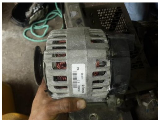
Figura 3.5 Alternador 65 A 12 V DC El autor 2016
