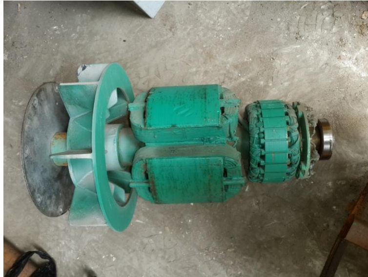
Figura 3.12 Rotor del generador MAGNAPLUS El autor 2016
