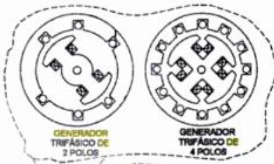
Figura 2.10 Rotor de dos y cuatro polos
