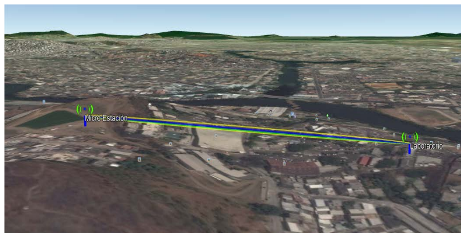
Figura 3. 9: Montaje de Radio Enlace desde la Micro-Estación al Laboratorio Elaborado por: Autor
